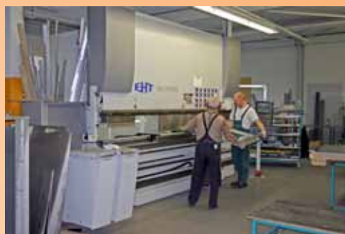
EHT Abkantpresse 225 t hier: Fertigung Tür für Kompaktstation
