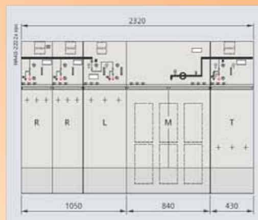
Übergabe mit Leistungsschalter im Block und Kabelanbindung: RRL M--T...
