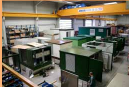
Montagehalle 2 - Fertigung Transformatorstationen
