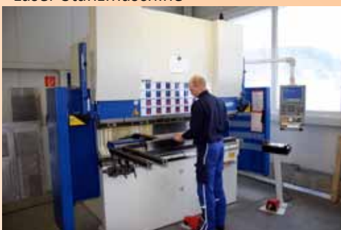
EHT Abkantpresse 85 t hier: Fertigung Lüftungselemente
